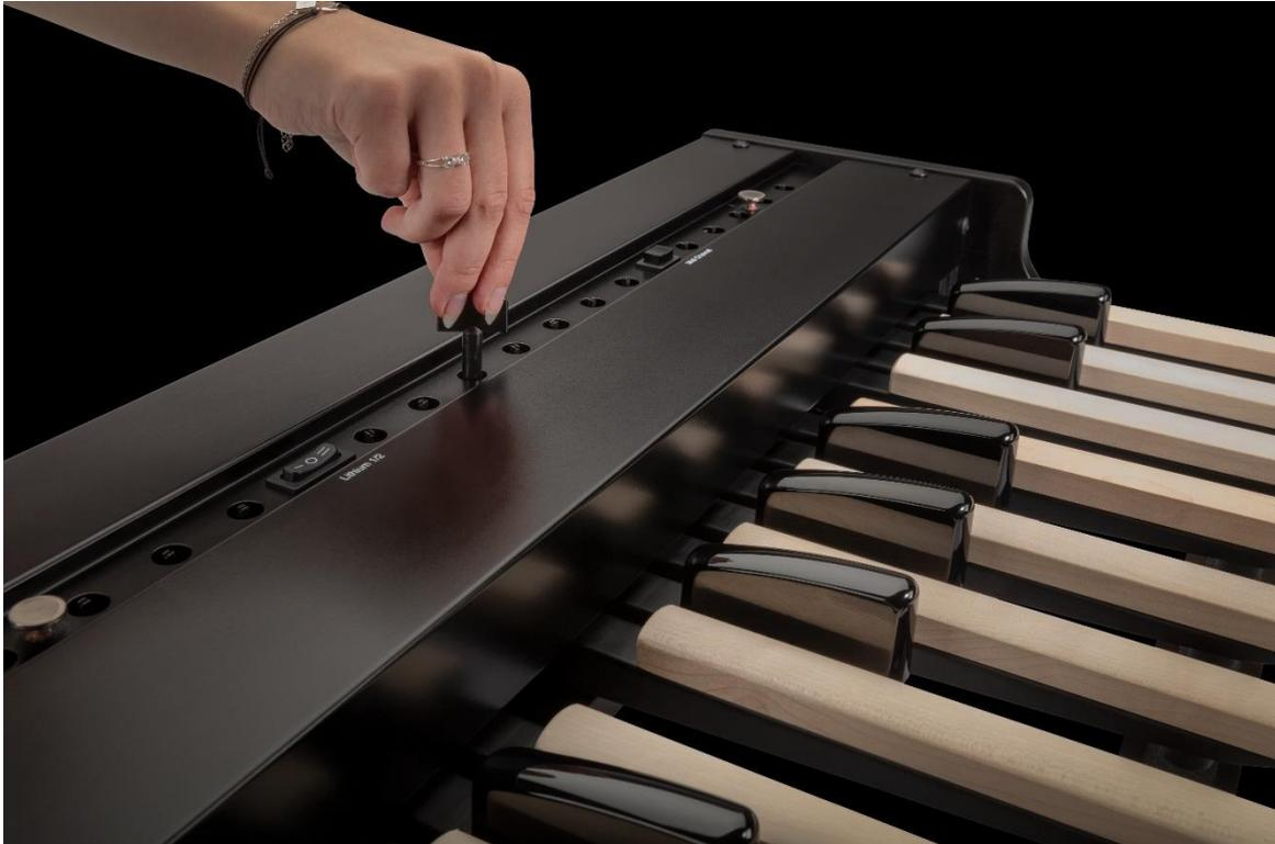
Die Auslösepunkte und damit der Hub der Tasten bis zum Auslösen des Tones können mittels eines kleinen Schlüssels individuell an die persönliche Spielweise angepasst werden, ohne das Instrument öffnen zu müssen! Es muss nur die schmale Abdeckung (Blechleiste), welche mit zwei Magneten gehalten wird, abgenommen werden.
