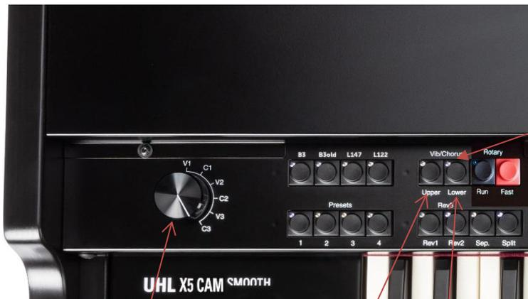
! Eine in den Tastern integrierte **Leuchtdiode** zeigt an (leuchtet) wenn ein Taster ausgewählt und betätigt wurde. Auch bei schlechten Lichtverhältnissen, z.B. auf der Bühne kann man leicht erkennen, welche Einstellungen gerade aktiv sind.
